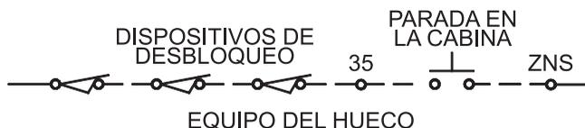
En la cabina: cuando se requiera, suministre un botón pulsador de parada, normalmente cerrado, cableado en serie con los Dispositivos de Desbloqueo. Se requieren botones de parada separados para cada línea de puertas, excepto cuando los embarques escalonados permiten el uso de un sólo controlador Peelle para más de una línea de puertas.
