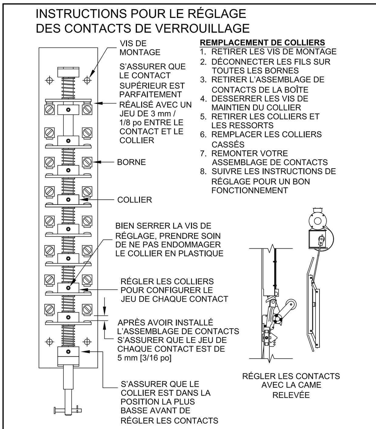
Figure 8 - Réglages des contacts du dispositif de verrouillage
