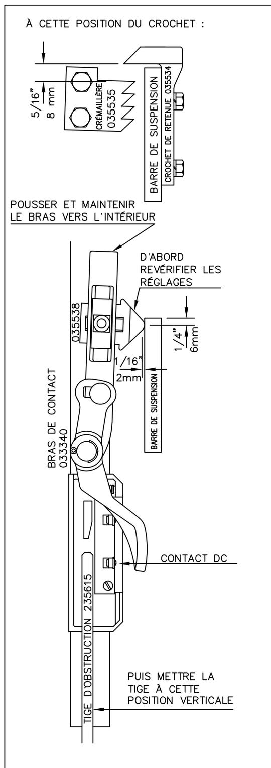
**Figure 4 - Réglage de la tige d'obstruction, position fermée**
