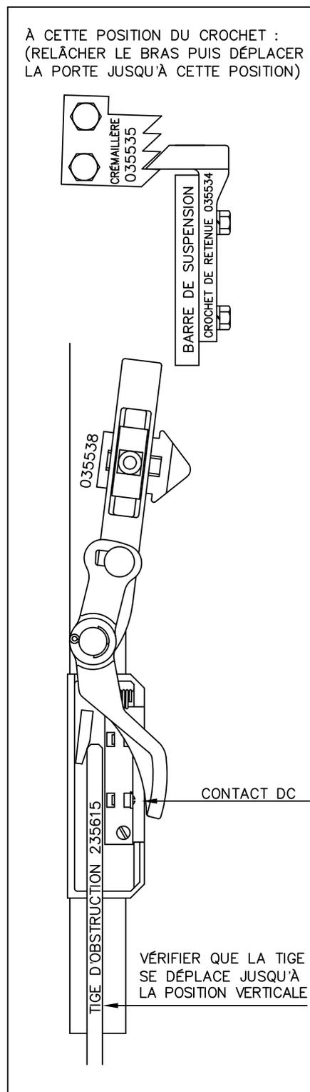
**Figure 5 - Réglage de la tige d'obstruction, position ouverte**
